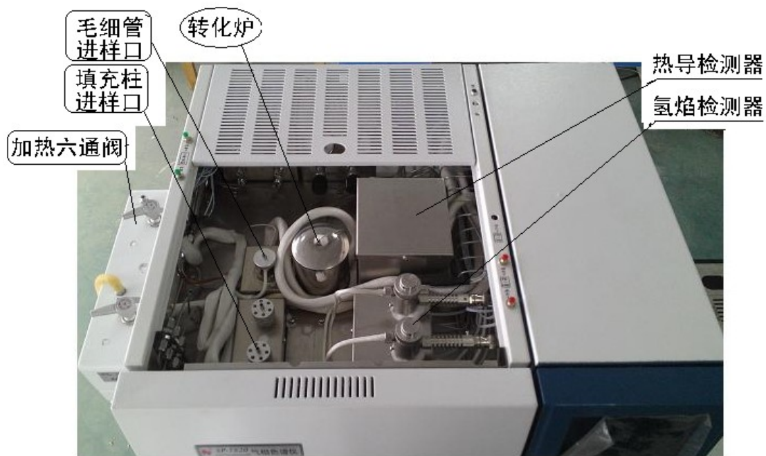
SP-7820型气相色谱仪-氢焰、热导、转化炉+加热六通阀 俯视图
