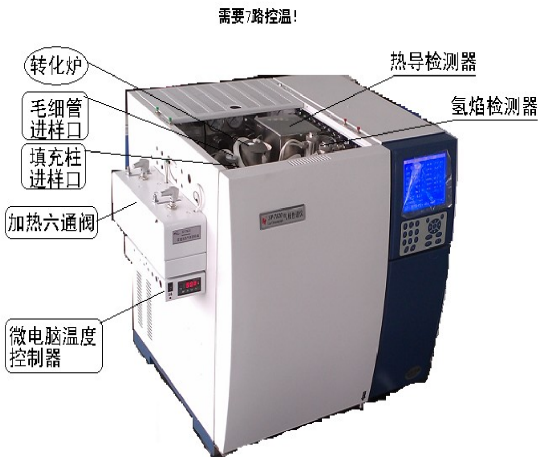
SP-7820型气相色谱仪-氢焰、热导、转化炉+加热六通阀
