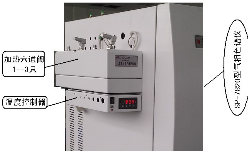
SP-7820型气相色谱仪-氢焰、热导、转化炉+ 加热六通阀 特写
